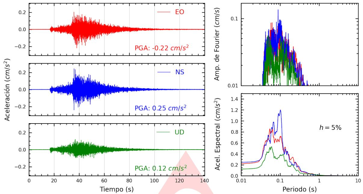
**Figura A.1:** Registros tiempo-historia, espectros de Fourier y de respuesta en las direcciones EO, NS y vertical de la estación UNSA. Sismo de Atico, Caraveli - Arequipa del 2023-01-17, 13:40:00 (Hora local)
