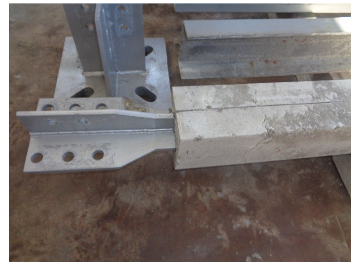
Resultados final (fisura del mortero)
