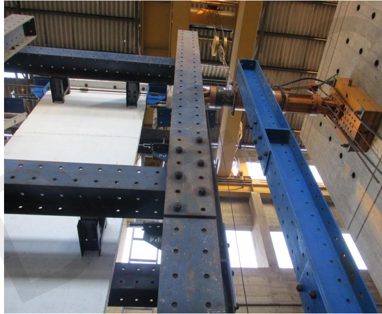
Ensayo de carga lateral cíclica en muro de ductilidad limitada de 5 niveles. Laboratorio de Estructuras- CISMID-FIC-UNI.
