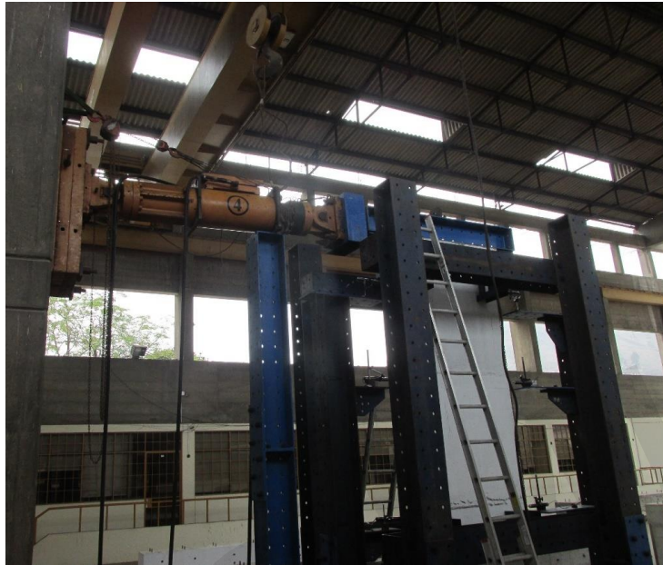
Ensayo de carga lateral cíclica en muro de ductilidad limitada de 5 niveles. Laboratorio de Estructuras- CISMID-FIC-UNI.
