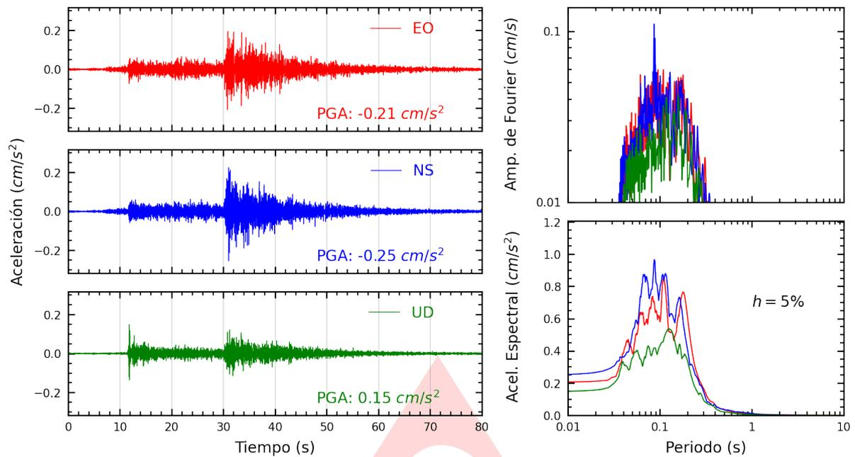
**Figura A.1:** Registros tiempo-historia, espectros de Fourier y de respuesta en las direcciones EO, NS y vertical de la estación UNSA. Sismo de Chuquibamba, Condesuyos - Arequipa del 2023-06-08, 12:11:10 (Hora local)
