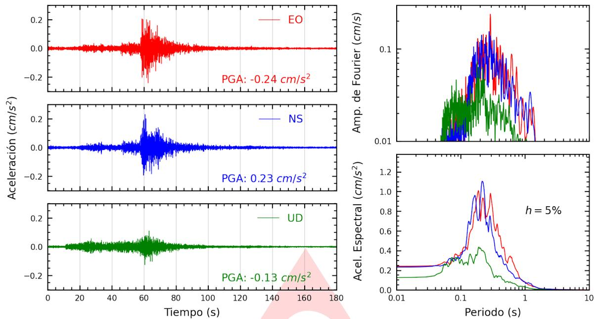
**Figura A.1:** Registros tiempo-historia, espectros de Fourier y de respuesta en las direcciones EO, NS y vertical de la estación UNAAA. Sismo de Sta. Maria De Nieva, Condorcanqui - Amazonas del 2023-08-20, 02:29:01 (Hora local)
