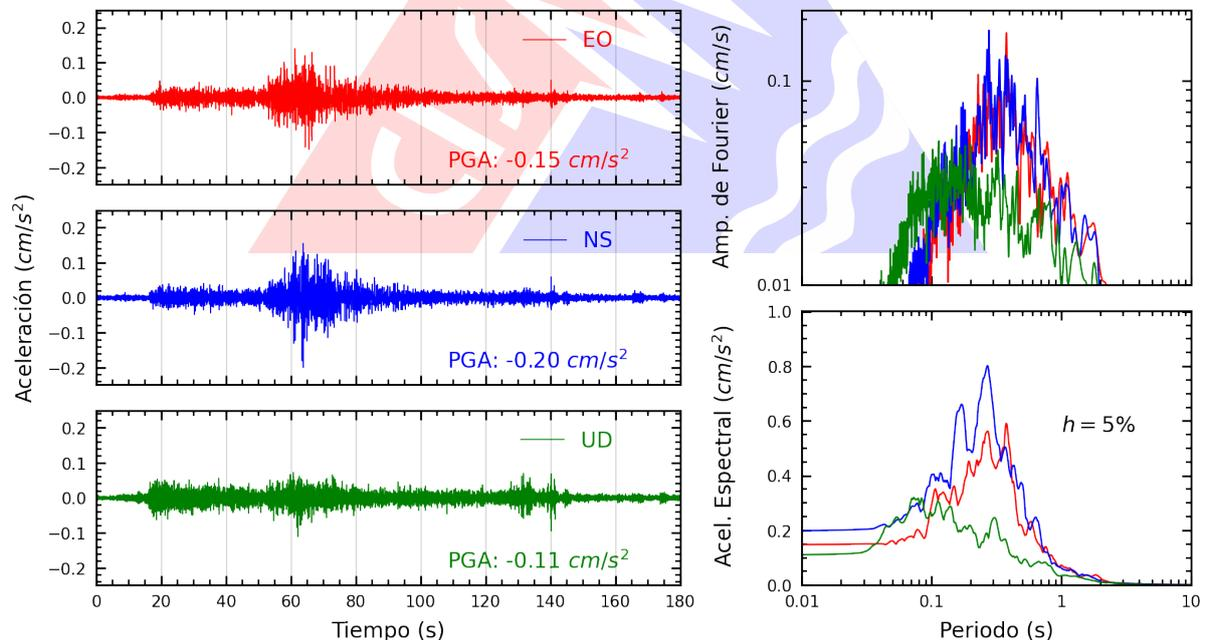
**Figura A.2:** Registros tiempo-historia, espectros de Fourier y de respuesta en las direcciones EO, NS y vertical de la estación UNP. Sismo de Sta. Maria De Nieva, Condorcanqui - Amazonas del 2023-08-20, 02:29:01 (Hora local)
