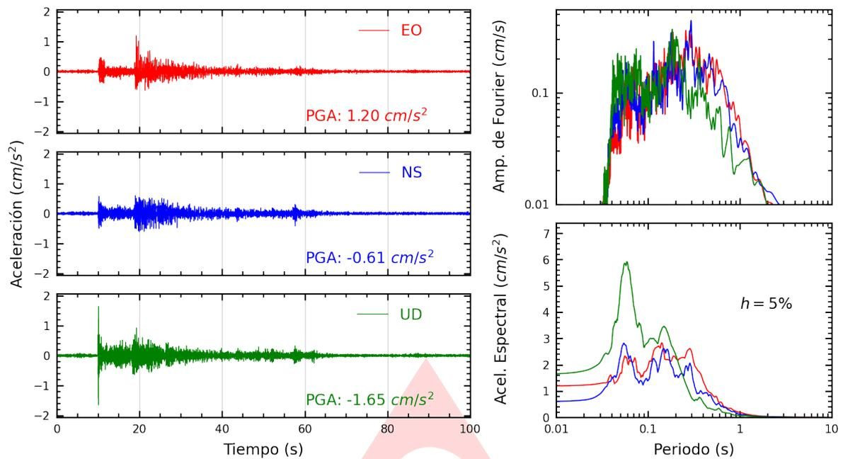
**Figura A.1:** Registros tiempo-historia, espectros de Fourier y de respuesta en las direcciones EO, NS y vertical de la estación UNICA. Sismo de Palpa, Palpa - Ica del 2023-09-22, 16:17:51 (Hora local)
