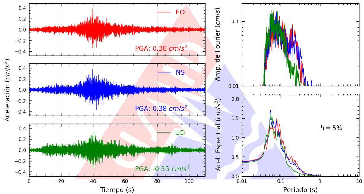
**Figura A.3:** Registros tiempo-historia, espectros de Fourier y de respuesta en las direcciones EO, NS y vertical de la estación ASIA. Sismo de Palpa, Palpa - Ica del 2023-09-22, 16:17:51 (Hora local)
