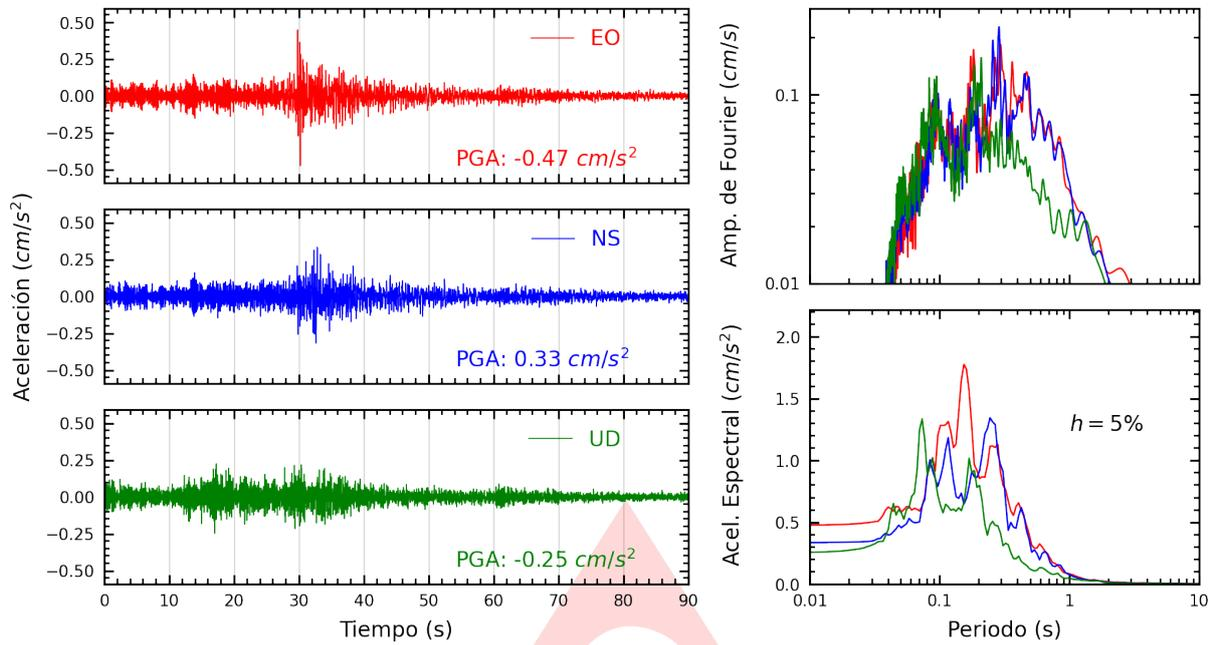
**Figura A.1:** Registros tiempo-historia, espectros de Fourier y de respuesta en las direcciones EO, NS y vertical de la estación UNICA. Sismo de Ica, Ica - Ica del 2023-12-06, 02:06:20 (Hora local)
