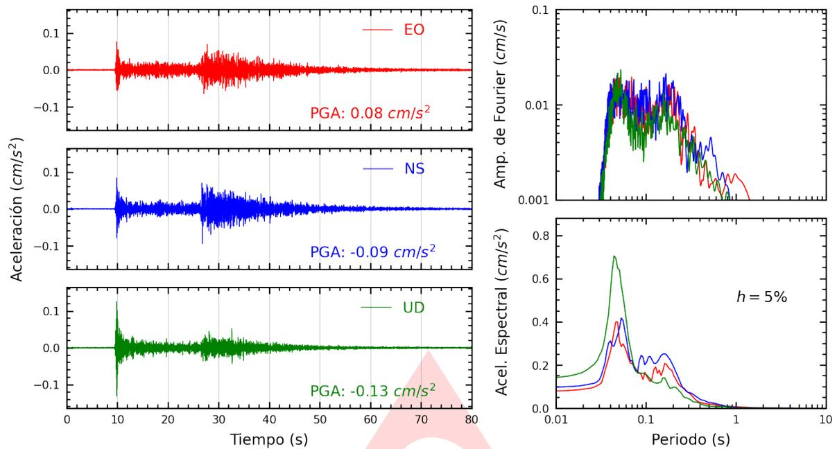
**Figura A.1:** Registros tiempo-historia, espectros de Fourier y de respuesta en las direcciones EO, NS y vertical de la estación UNSA. Sismo de Chuquibamba, Condesuyos - Arequipa del 2023-12-22, 06:28:36 (Hora local)
