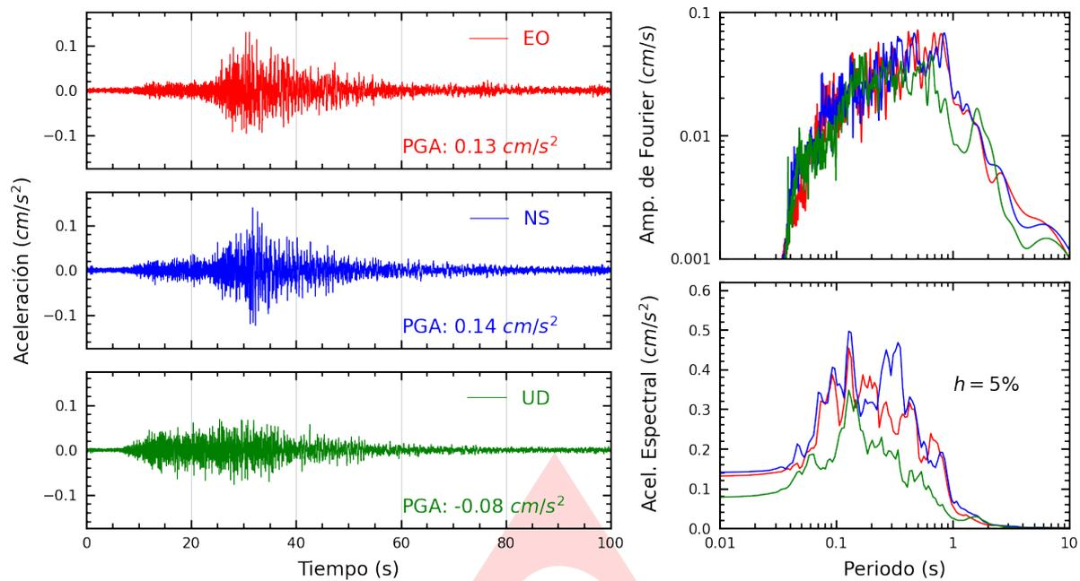
**Figura A.1:** Registros tiempo-historia, espectros de Fourier y de respuesta en las direcciones EO, NS y vertical de la estación UNF. Sismo de Zorritos, Contralmirante Villar - Tumbes del 2024-01-07, 10:08:25 (Hora local)
