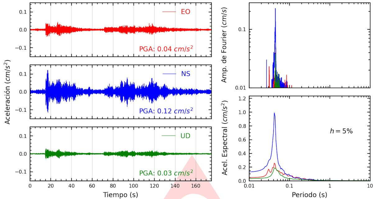
**Figura A.1:** Registros tiempo-historia, espectros de Fourier y de respuesta en las direcciones EO, NS y vertical de la estación UNAM. Sismo de La Capilla, General Sanchez Cerro - Moquegua del 2024-03-09, 05:04:24 (Hora local)
