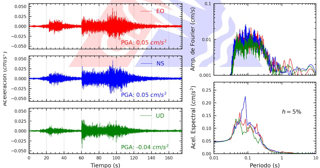
**Figura A.2:** Registros tiempo-historia, espectros de Fourier y de respuesta en las direcciones EO, NS y vertical de la estación UNSA. Sismo de La Capilla, General Sanchez Cerro - Moquegua del 2024-03-09, 05:04:24 (Hora local)
