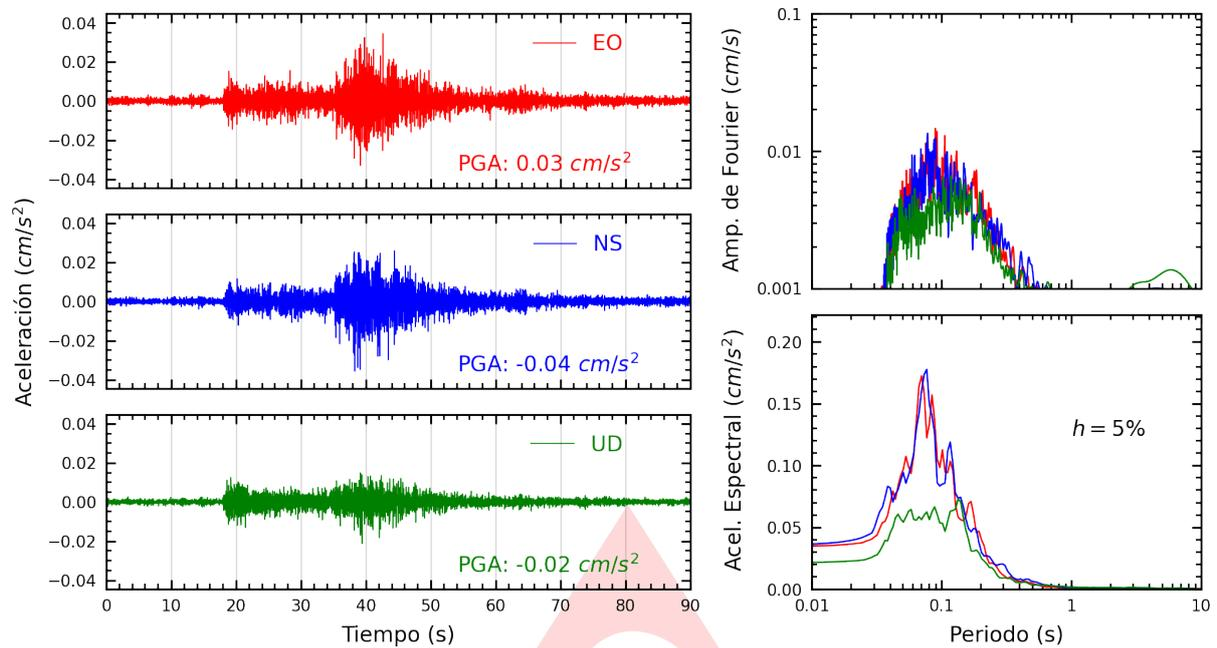
**Figura A.1:** Registros tiempo-historia, espectros de Fourier y de respuesta en las direcciones EO, NS y vertical de la estación UNSA. Sismo de Chivay, Caylloma - Arequipa del 2024-03-13, 16:28:48 (Hora local)
