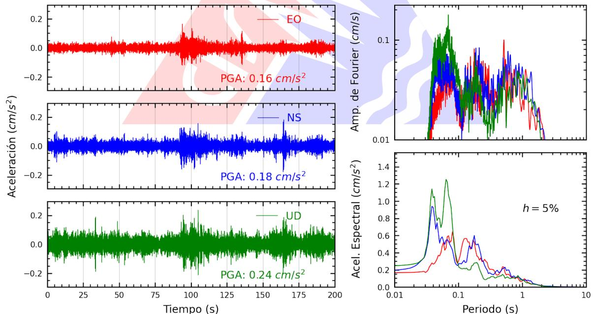
**Figura A.2:** Registros tiempo-historia, espectros de Fourier y de respuesta en las direcciones EO, NS y vertical de la estación SCHYO. Sismo de Pucallpa, Coronel Portillo - Ucayali del 2024-03-27, 09:16:14 (Hora local)
