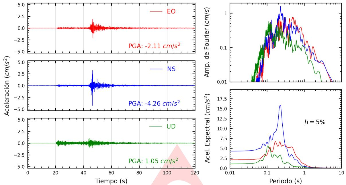
**Figura A.1:** Registros tiempo-historia, espectros de Fourier y de respuesta en las direcciones EO, NS y vertical de la estación UNIA. Sismo de Pucallpa, Coronel Portillo - Ucayali del 2024-03-27, 09:16:14 (Hora local)
