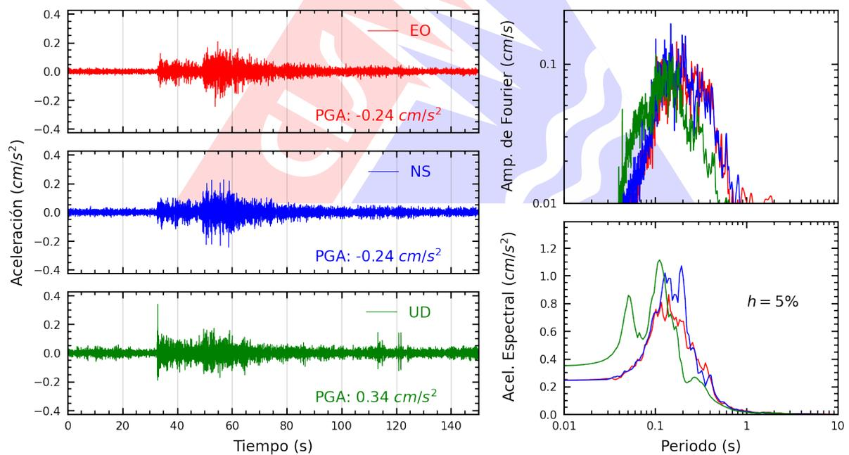
**Figura A.2:** Registros tiempo-historia, espectros de Fourier y de respuesta en las direcciones EO, NS y vertical de la estación UNP. Sismo de Talara, Talara - Piura del 2024-05-07, 17:22:47 (Hora local)
