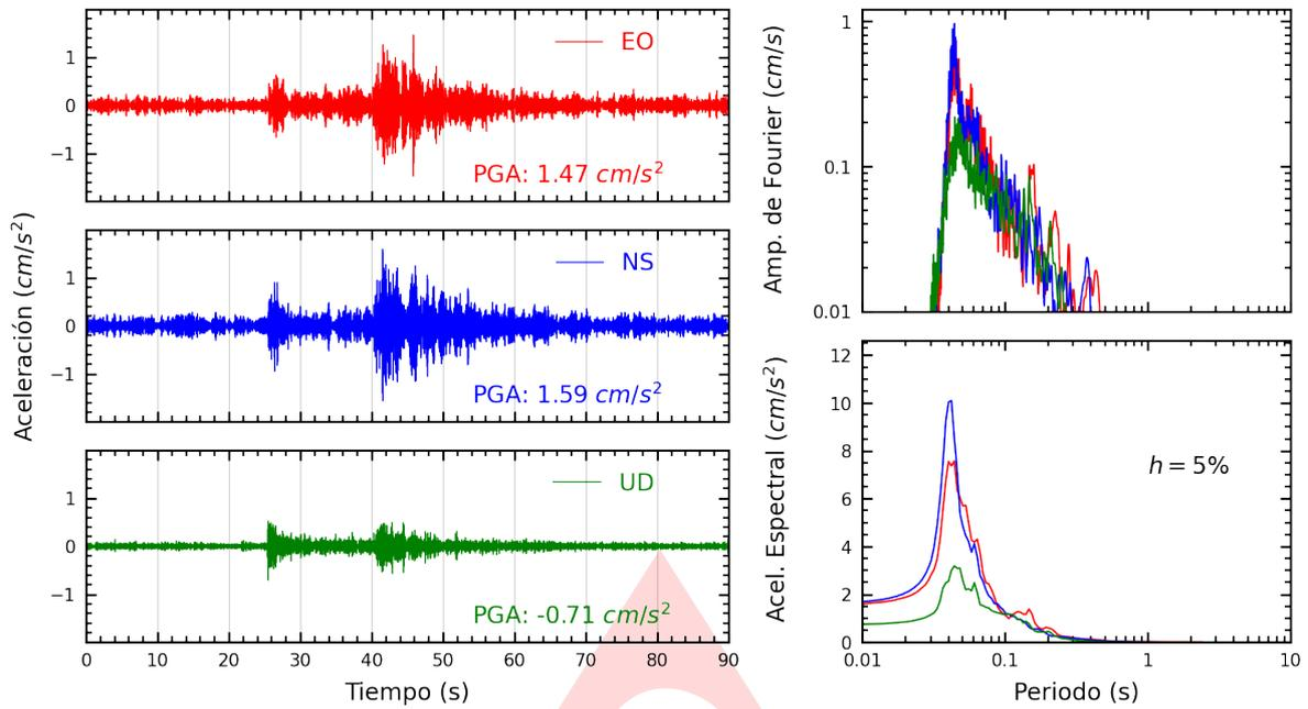
**Figura A.1:** Registros tiempo-historia, espectros de Fourier y de respuesta en las direcciones EO, NS y vertical de la estación SCTRU. Sismo de Chimbote, Santa - Ancash del 2024-05-12, 09:54:34 (Hora local)
