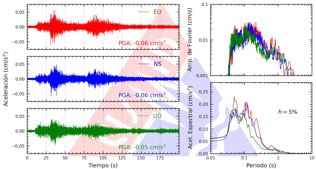
**Figura A.7:** Registros tiempo-historia, espectros de Fourier y de respuesta en las direcciones EO, NS y vertical de la estación JALV2. Sismo de Ica, Ica - Ica del 2024-05-16, 00:02:47 (Hora local)
