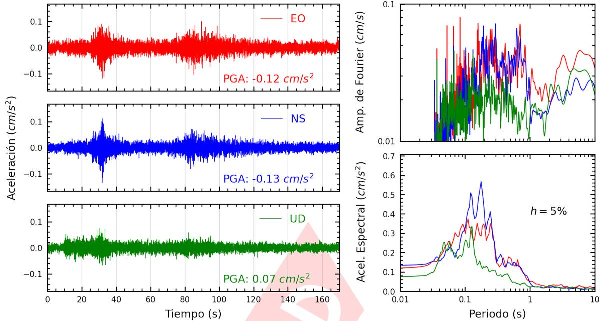
**Figura A.5:** Registros tiempo-historia, espectros de Fourier y de respuesta en las direcciones EO, NS y vertical de la estación USILP. Sismo de Ica, Ica - Ica del 2024-05-16, 00:02:47 (Hora local)
