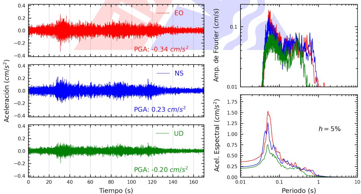
**Figura A.4:** Registros tiempo-historia, espectros de Fourier y de respuesta en las direcciones EO, NS y vertical de la estación UNTEL. Sismo de Ica, Ica - Ica del 2024-05-16, 00:02:47 (Hora local)
