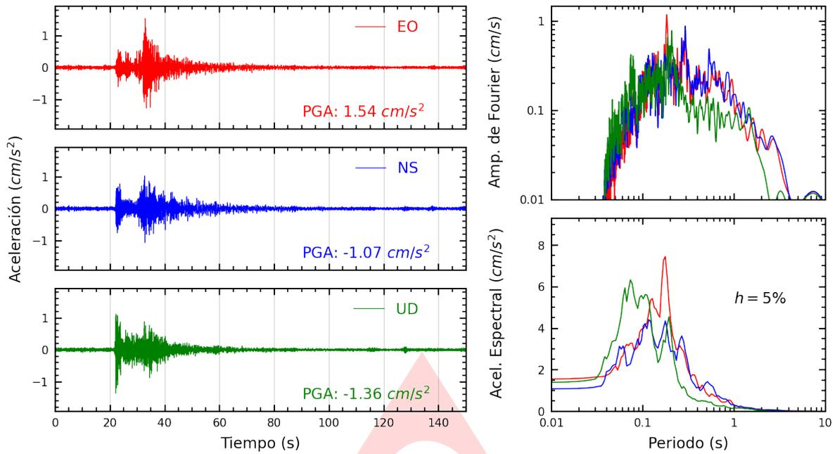
**Figura A.1:** Registros tiempo-historia, espectros de Fourier y de respuesta en las direcciones EO, NS y vertical de la estación UNICA. Sismo de Ica, Ica - Ica del 2024-05-16, 00:02:47 (Hora local)
