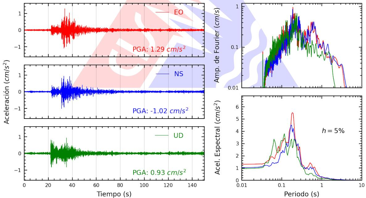
**Figura A.2:** Registros tiempo-historia, espectros de Fourier y de respuesta en las direcciones EO, NS y vertical de la estación SCICA. Sismo de Ica, Ica - Ica del 2024-05-16, 00:02:47 (Hora local)
