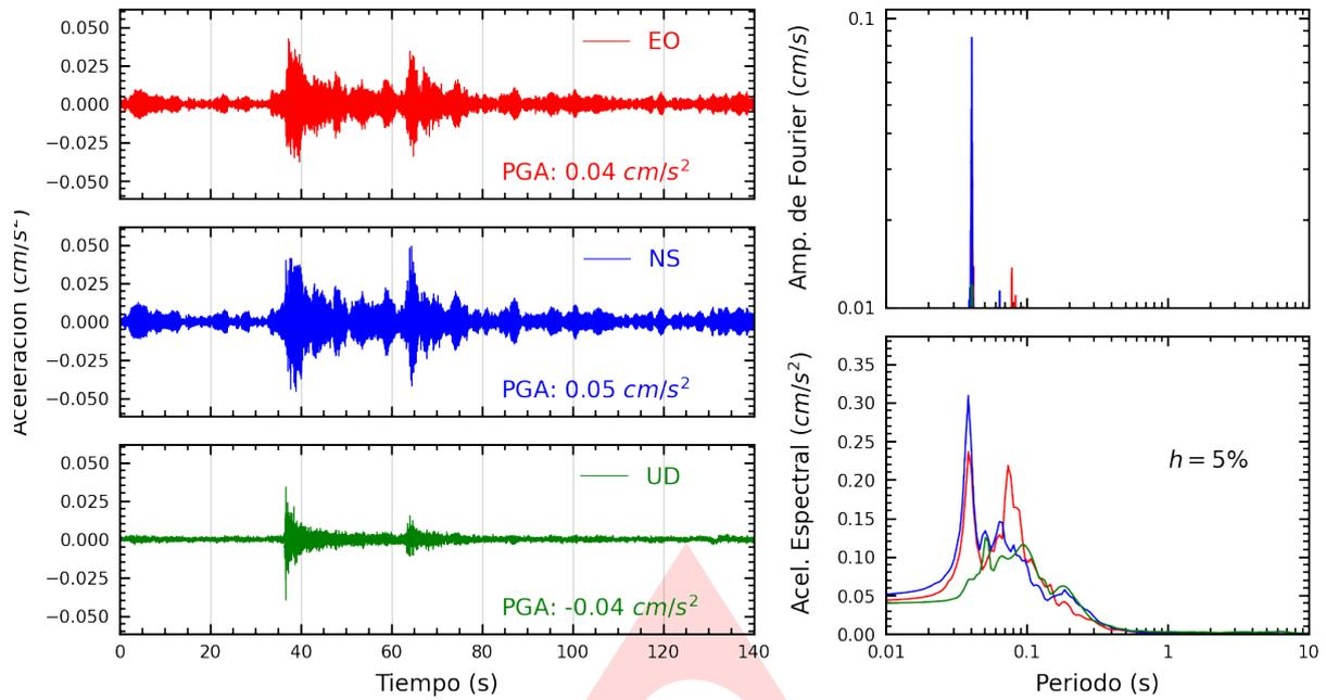
**Figura A.1:** Registros tiempo-historia, espectros de Fourier y de respuesta en las direcciones EO, NS y vertical de la estación UNAM. Sismo de Chivay, Caylloma - Arequipa del 2024-06-11, 01:10:19 (Hora local)
