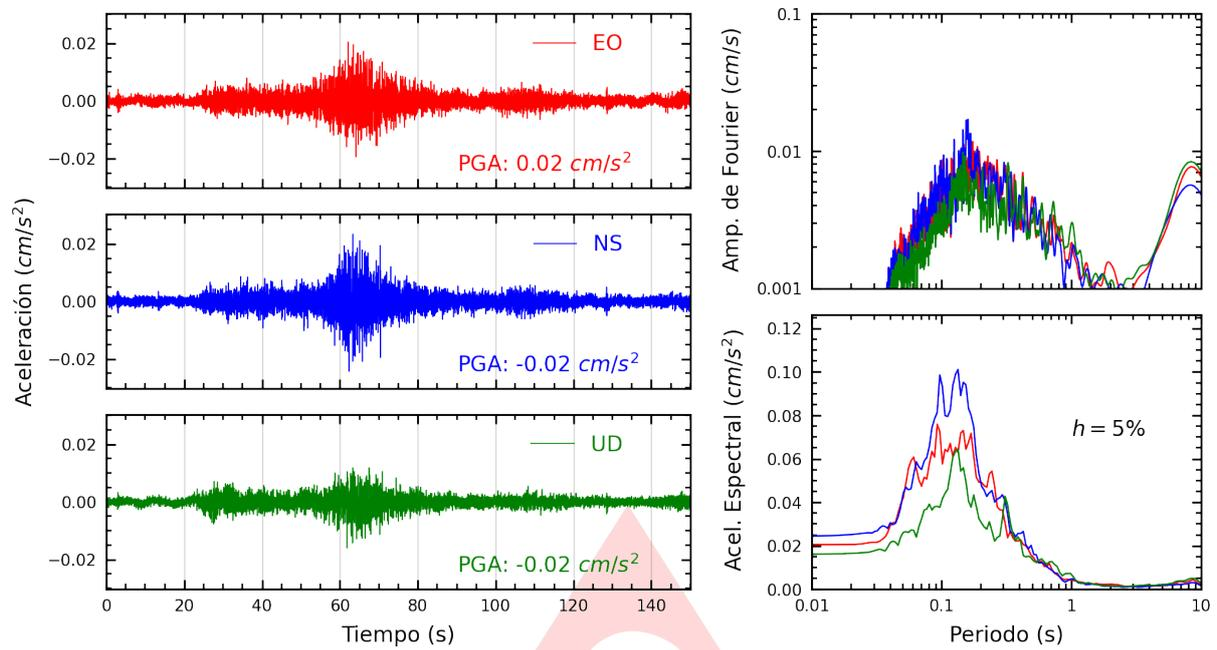
**Figura A.1:** Registros tiempo-historia, espectros de Fourier y de respuesta en las direcciones EO, NS y vertical de la estación UNSA. Sismo de Yauca, Caraveli - Arequipa del 2024-06-28, 01:26:56 (Hora local)
