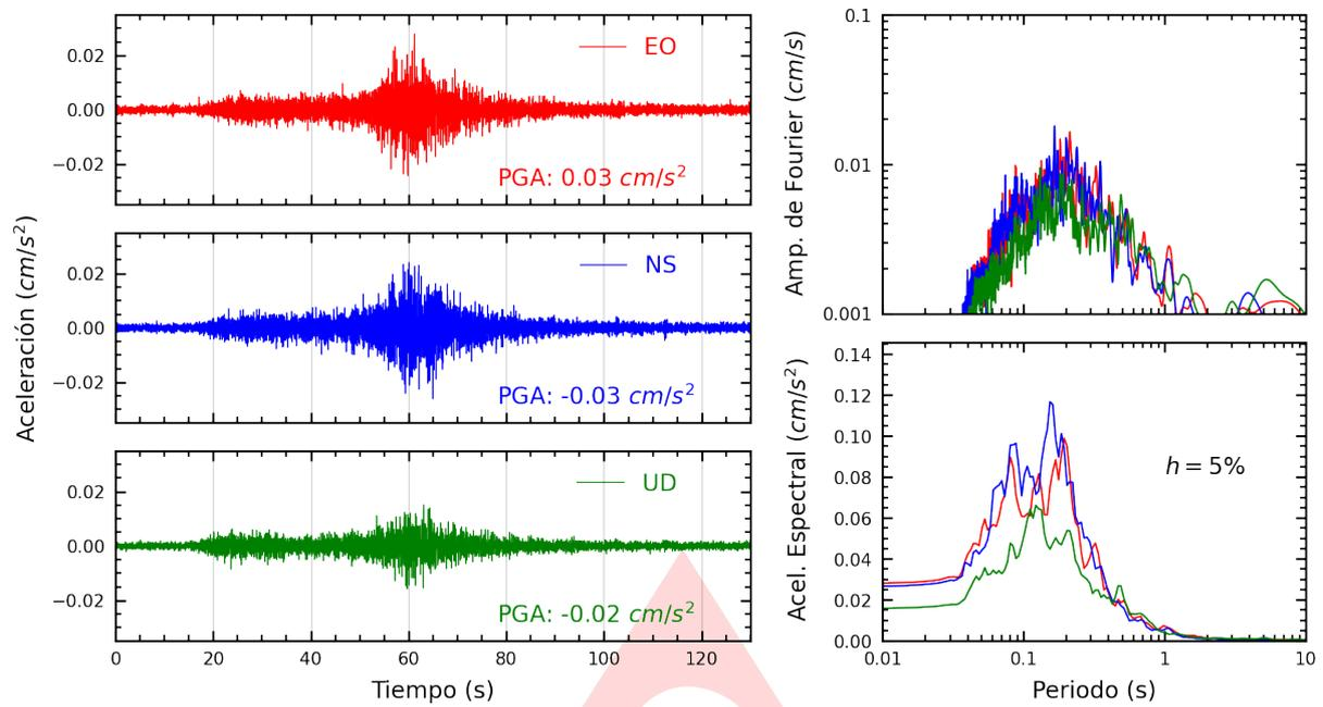
**Figura A.1:** Registros tiempo-historia, espectros de Fourier y de respuesta en las direcciones EO, NS y vertical de la estación UNSA. Sismo de Yauca, Caraveli - Arequipa del 2024-06-28, 02:26:39 (Hora local)
