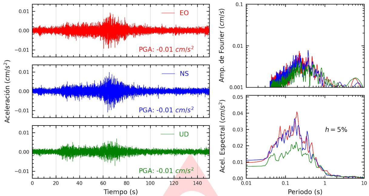
**Figura A.1:** Registros tiempo-historia, espectros de Fourier y de respuesta en las direcciones EO, NS y vertical de la estación UNSA. Sismo de Chala, Caraveli - Arequipa del 2024-06-29, 05:09:08 (Hora local)
