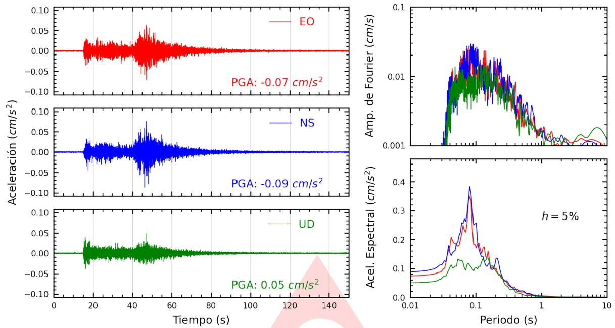
**Figura A.1:** Registros tiempo-historia, espectros de Fourier y de respuesta en las direcciones EO, NS y vertical de la estación UNSA. Sismo de Huayhuahuasi, Espinar - Cusco del 2024-06-12, 15:18:21 (Hora local)
