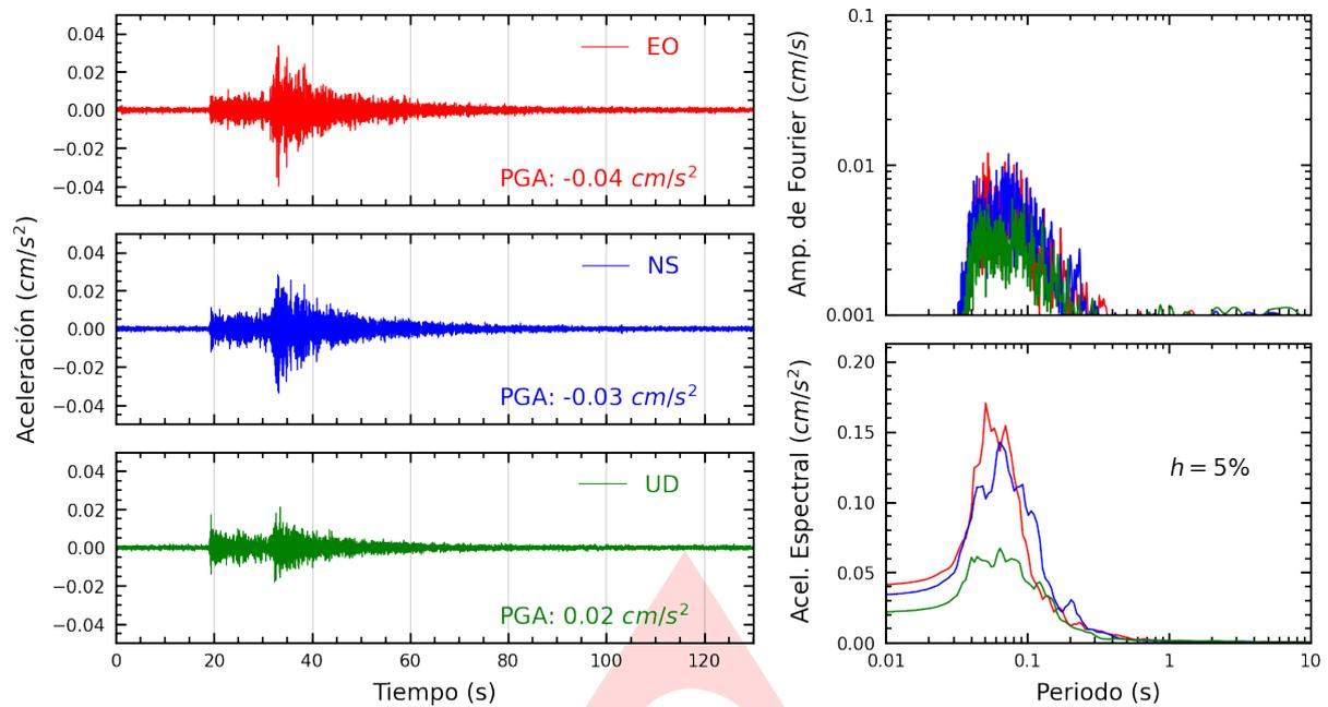
**Figura A.1:** Registros tiempo-historia, espectros de Fourier y de respuesta en las direcciones EO, NS y vertical de la estación UNSA. Sismo de Ilo, Ilo - Moquegua del 2024-06-19, 18:47:40 (Hora local)
