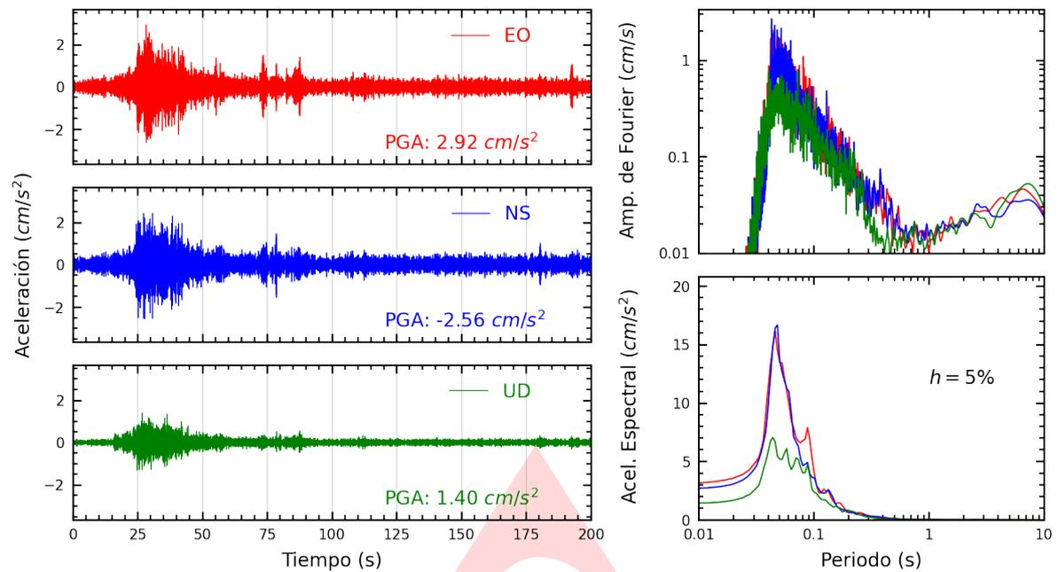
**Figura A.1:** Registros tiempo-historia, espectros de Fourier y de respuesta en las direcciones EO, NS y vertical de la estación USP. Sismo de Chimbote, Santa - Ancash del 2024-07-01, 09:13:03 (Hora local)
