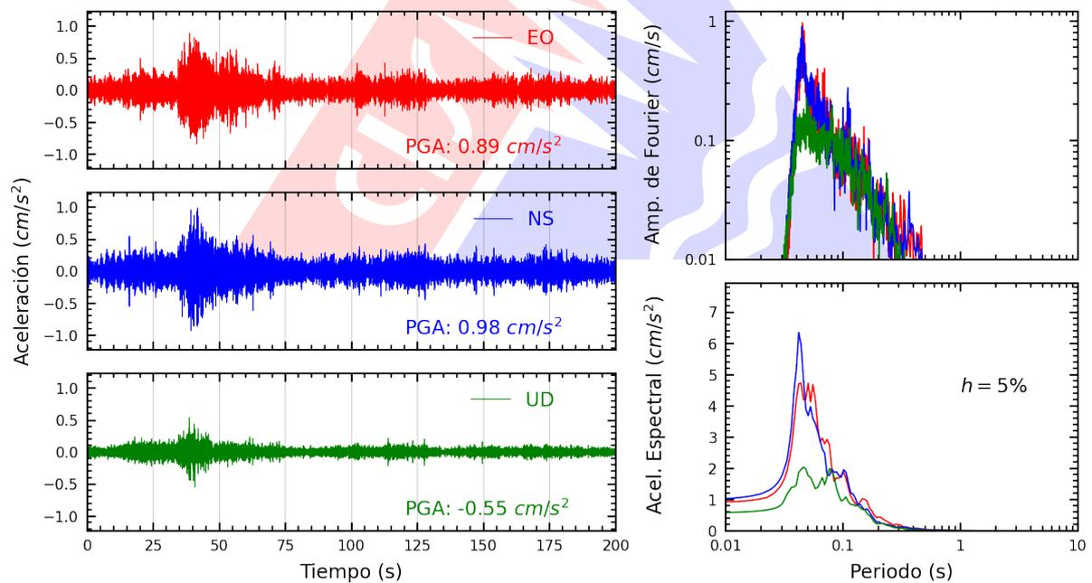
**Figura A.2:** Registros tiempo-historia, espectros de Fourier y de respuesta en las direcciones EO, NS y vertical de la estación SCTR. Sismo de Chimbote, Santa - Ancash del 2024-07-01, 09:13:03 (Hora local)
