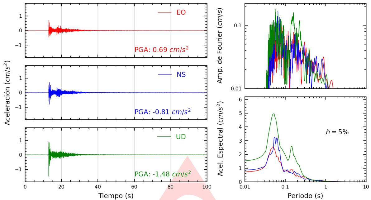
**Figura A.1:** Registros tiempo-historia, espectros de Fourier y de respuesta en las direcciones EO, NS y vertical de la estación UNCP. Sismo de Jauja, Jauja - Junin del 2024-07-05, 03:13:05 (Hora local)
