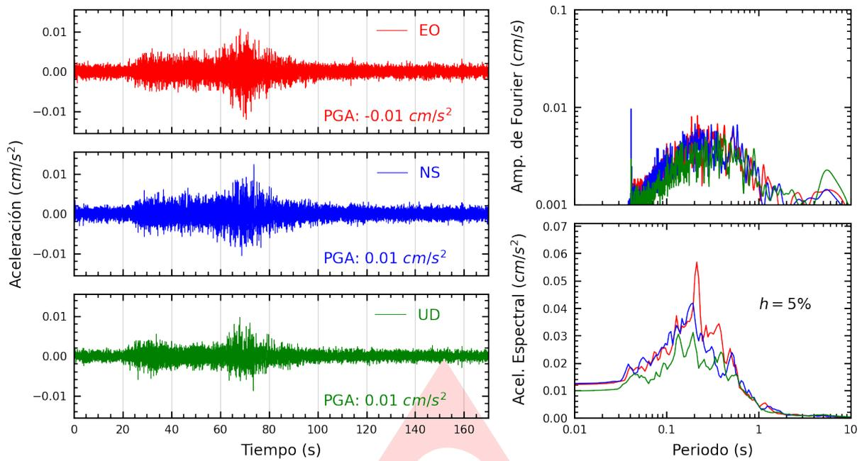
**Figura A.1:** Registros tiempo-historia, espectros de Fourier y de respuesta en las direcciones EO, NS y vertical de la estación UNSA. Sismo de Lomas, Caraveli - Arequipa del 2024-07-09, 02:38:40 (Hora local)
