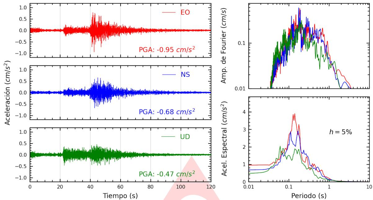
**Figura A.1:** Registros tiempo-historia, espectros de Fourier y de respuesta en las direcciones EO, NS y vertical de la estación UNICA. Sismo de Sancos, Huanca Sancos - Ayacucho del 2024-07-10, 07:22:22 (Hora local)
