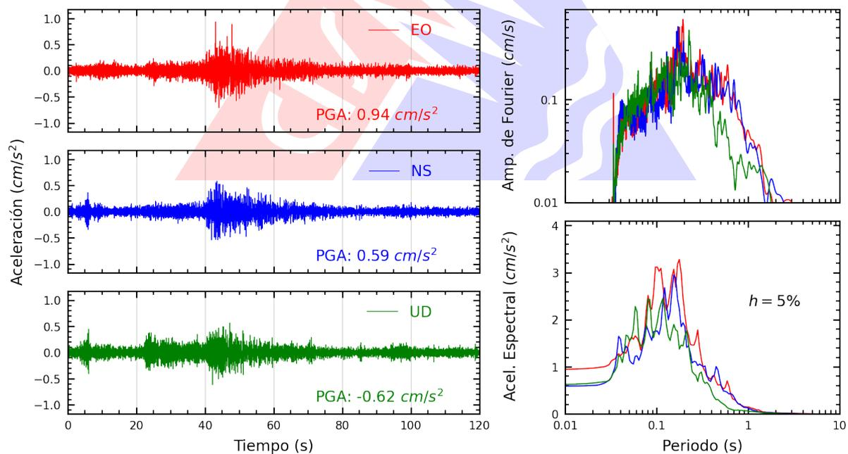
**Figura A.2:** Registros tiempo-historia, espectros de Fourier y de respuesta en las direcciones EO, NS y vertical de la estación SCICA. Sismo de Sancos, Huanca Sancos - Ayacucho del 2024-07-10, 07:22:22 (Hora local)
