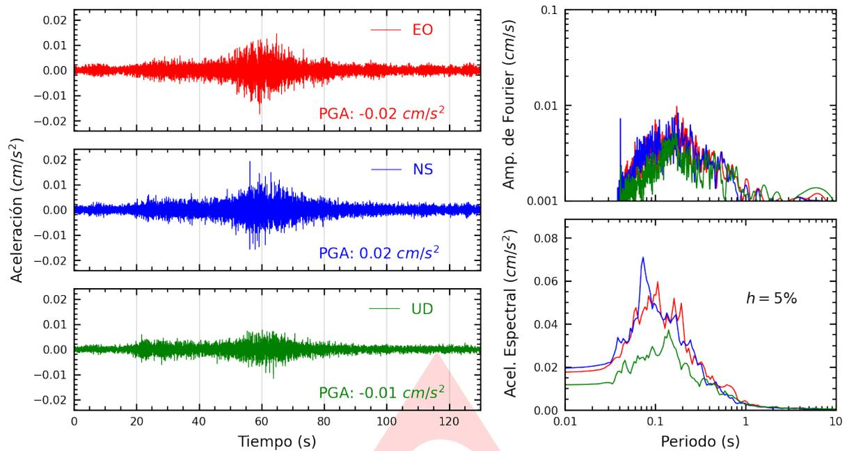
**Figura A.1:** Registros tiempo-historia, espectros de Fourier y de respuesta en las direcciones EO, NS y vertical de la estación UNSA. Sismo de Chala, Caraveli - Arequipa del 2024-07-14, 03:22:52 (Hora local)
