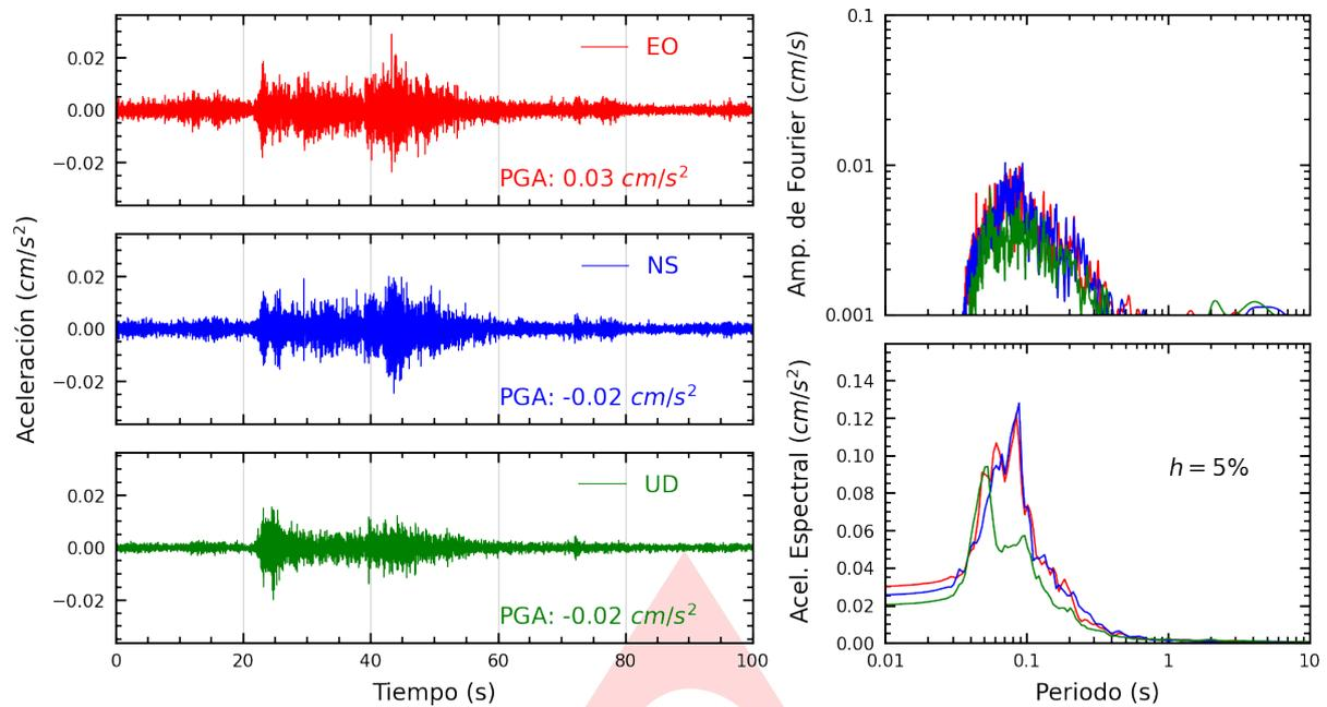
**Figura A.1:** Registros tiempo-historia, espectros de Fourier y de respuesta en las direcciones EO, NS y vertical de la estación UNSA. Sismo de Maca, Caylloma - Arequipa del 2024-07-14, 14:57:38 (Hora local)
