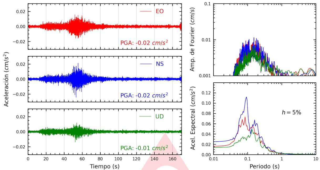
**Figura A.1:** Registros tiempo-historia, espectros de Fourier y de respuesta en las direcciones EO, NS y vertical de la estación UNSA. Sismo de Chala, Caraveli - Arequipa del 2024-07-16, 18:13:01 (Hora local)
