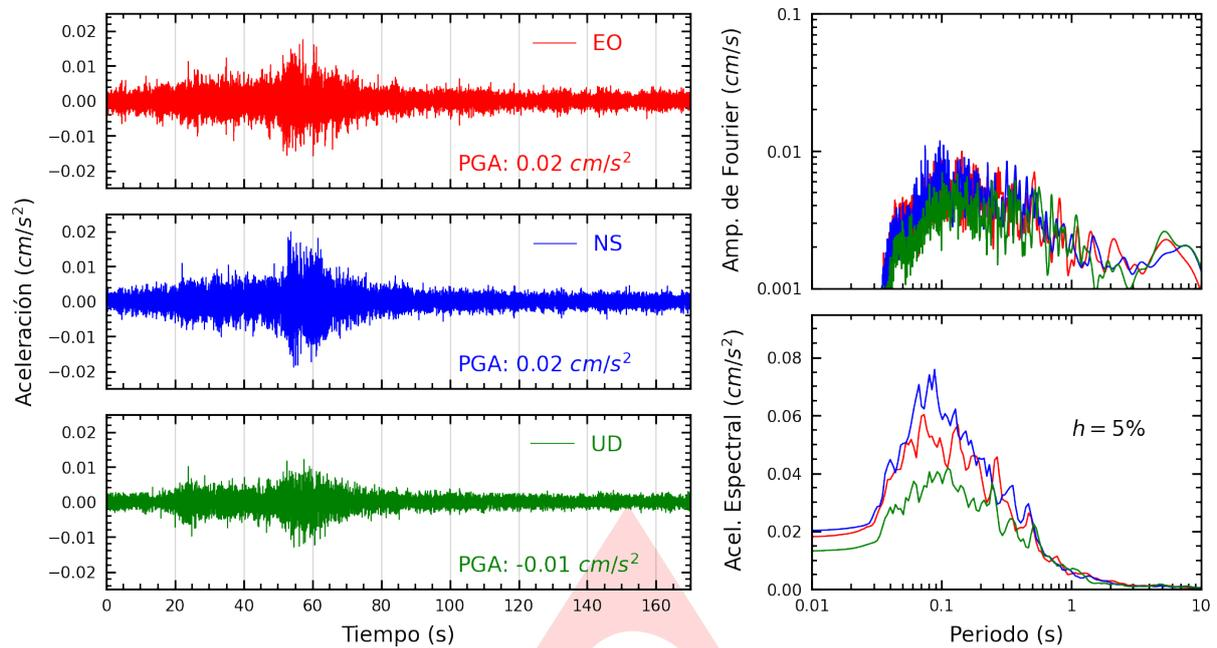
**Figura A.1:** Registros tiempo-historia, espectros de Fourier y de respuesta en las direcciones EO, NS y vertical de la estación UNSA. Sismo de Chala, Caraveli - Arequipa del 2024-07-29, 13:54:37 (Hora local)
