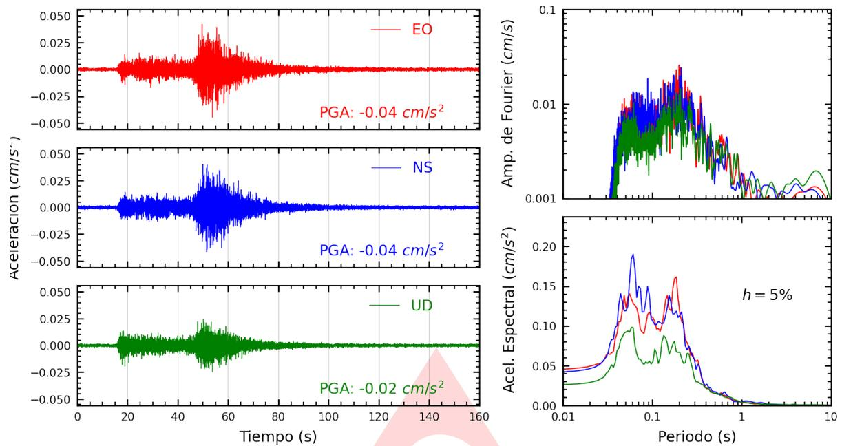
**Figura A.1:** Registros tiempo-historia, espectros de Fourier y de respuesta en las direcciones EO, NS y vertical de la estación UNSA. Sismo de Coracora, Parinacochas - Ayacucho del 2024-08-21, 05:25:13 (Hora local)
