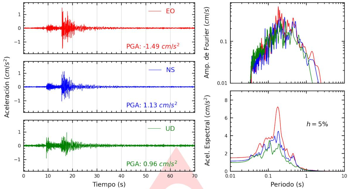
**Figura A.1:** Registros tiempo-historia, espectros de Fourier y de respuesta en las direcciones EO, NS y vertical de la estación SCCUS. Sismo de Paruro, Paruro - Cusco del 2024-08-23, 11:05:32 (Hora local)
