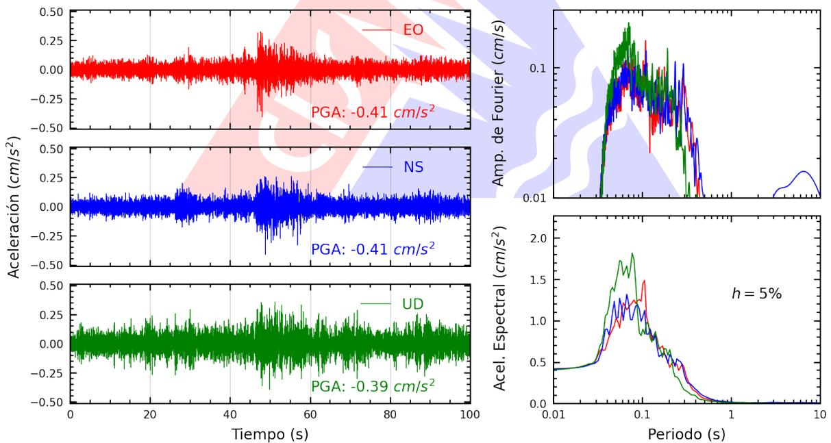
**Figura A.2:** Registros tiempo-historia, espectros de Fourier y de respuesta en las direcciones EO, NS y vertical de la estación SCTAC. Sismo de Calana, Tacna - Tacna del 2024-04-29, 09:49:38 (Hora local)
