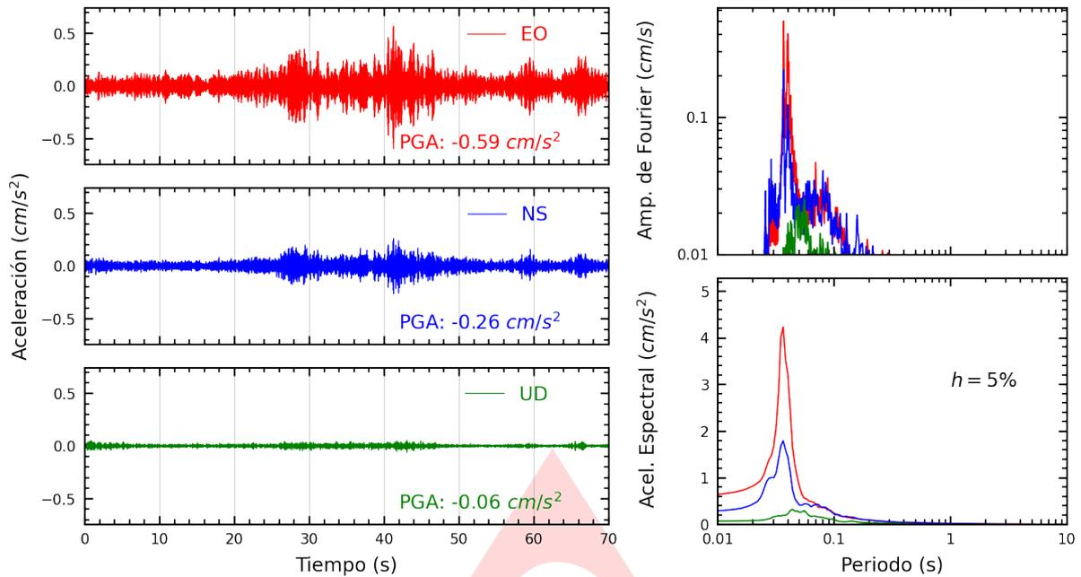
**Figura A.1:** Registros tiempo-historia, espectros de Fourier y de respuesta en las direcciones EO, NS y vertical de la estación UNAM. Sismo de Calana, Tacna - Tacna del 2024-04-29, 09:49:38 (Hora local)
