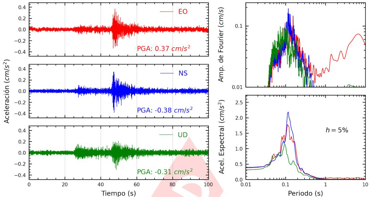
**Figura A.3:** Registros tiempo-historia, espectros de Fourier y de respuesta en las direcciones EO, NS y vertical de la estación UJBG3. Sismo de Calana, Tacna - Tacna del 2024-04-29, 09:49:38 (Hora local)
