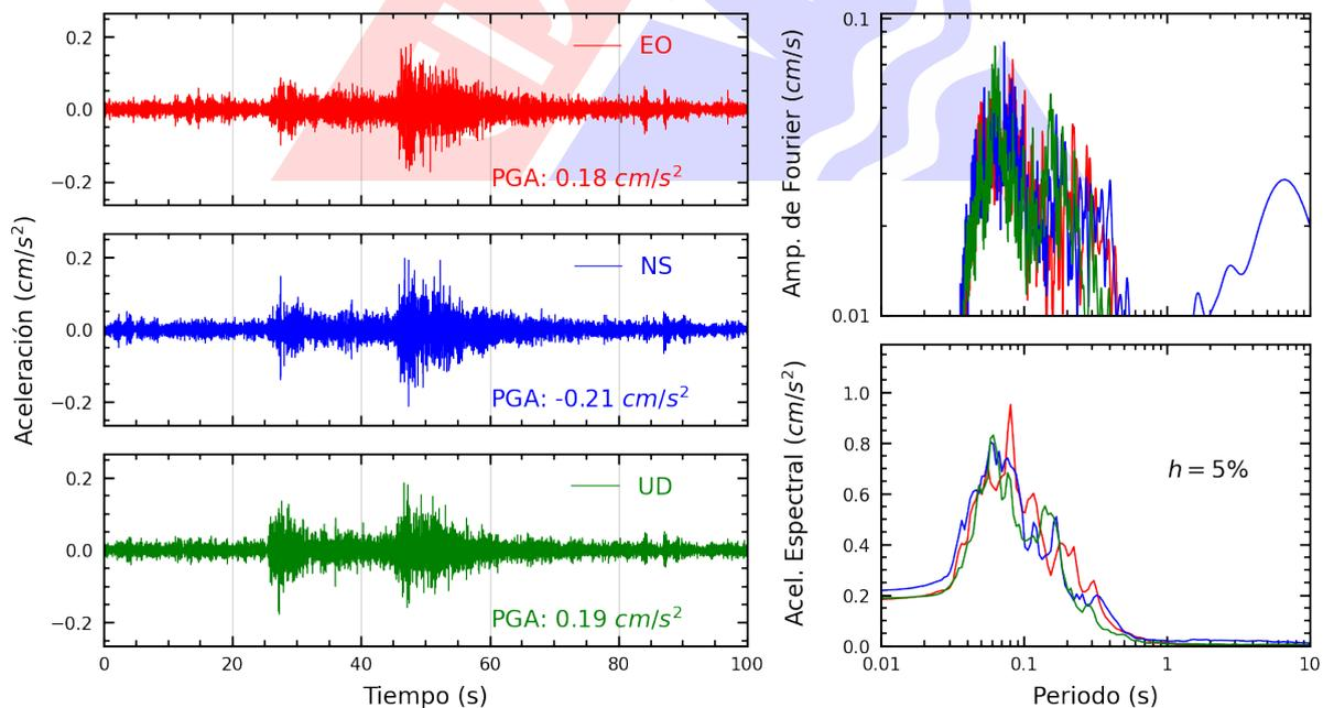
**Figura A.4:** Registros tiempo-historia, espectros de Fourier y de respuesta en las direcciones EO, NS y vertical de la estación CREY. Sismo de Calana, Tacna - Tacna del 2024-04-29, 09:49:38 (Hora local)
