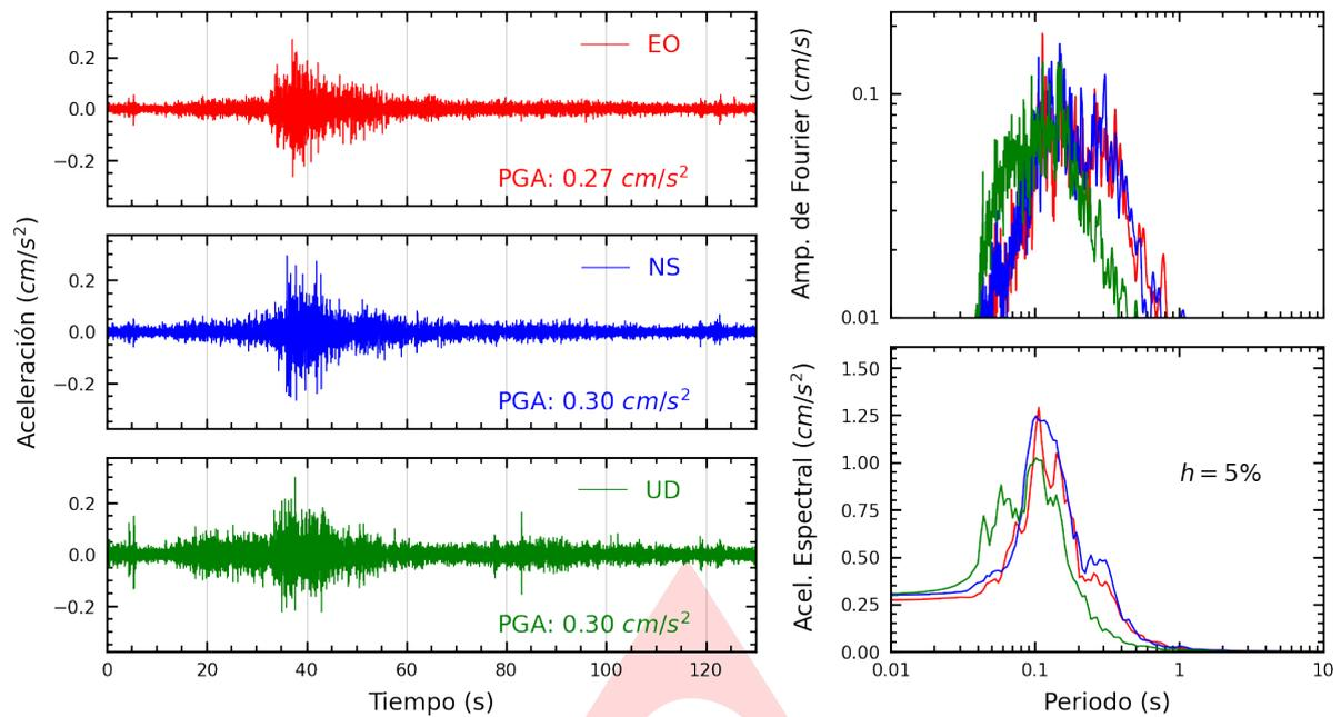
**Figura A.1:** Registros tiempo-historia, espectros de Fourier y de respuesta en las direcciones EO, NS y vertical de la estación UNP. Sismo de Tumbes, Tumbes - Tumbes del 2024-05-03, 09:19:27 (Hora local)
