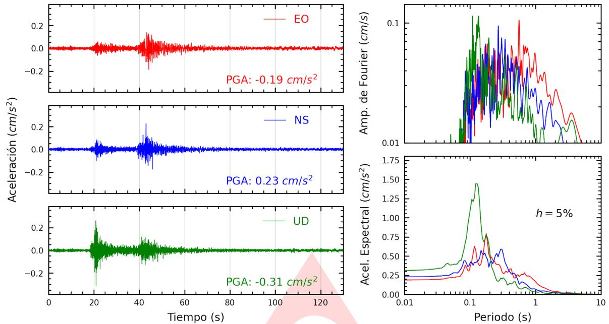
**Figura A.1:** Registros tiempo-historia, espectros de Fourier y de respuesta en las direcciones EO, NS y vertical de la estación UNIA. Sismo de Aguaytia, Padre Abad - Ucayali del 2024-05-03, 14:34:03 (Hora local)
