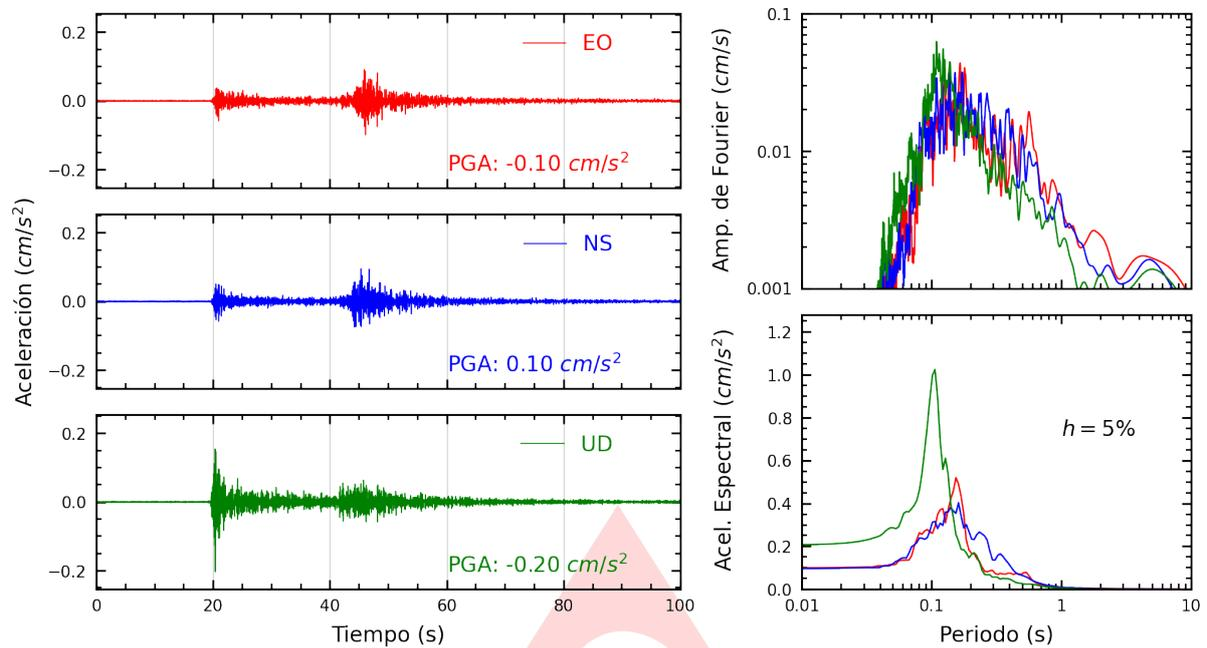
**Figura A.1:** Registros tiempo-historia, espectros de Fourier y de respuesta en las direcciones EO, NS y vertical de la estación UNIA. Sismo de Aucayacu, Leoncio Prado - Huanuco del 2024-05-04, 23:16:37 (Hora local)
