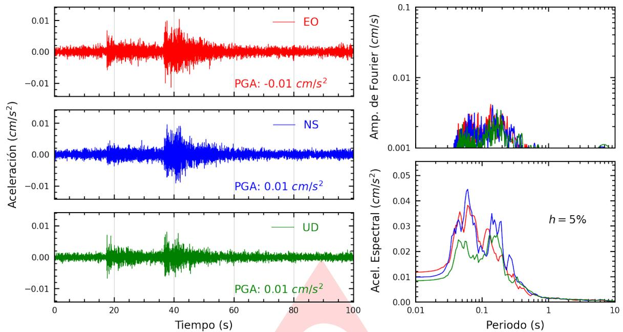
**Figura A.1:** Registros tiempo-historia, espectros de Fourier y de respuesta en las direcciones EO, NS y vertical de la estación UNSA2. Sismo de Chivay, Caylloma - Arequipa del 2024-06-13, 11:17:11 (Hora local)
