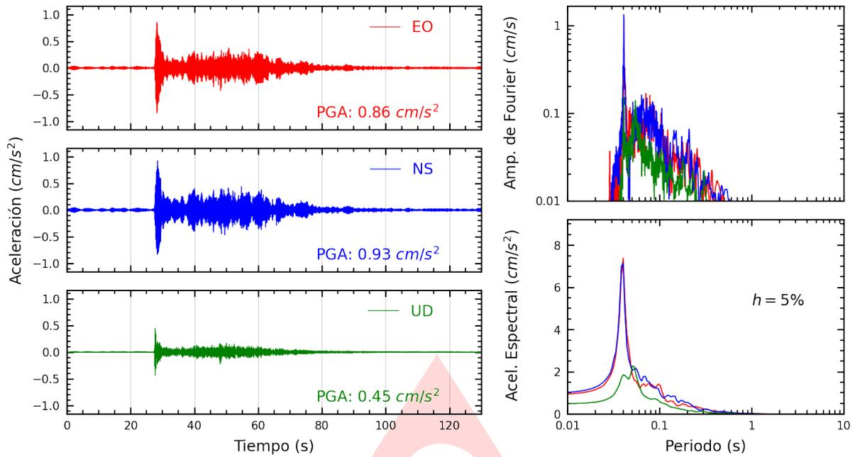
**Figura A.1:** Registros tiempo-historia, espectros de Fourier y de respuesta en las direcciones EO, NS y vertical de la estación UNAM. Sismo de Tacna, Tacna - Tacna del 2024-06-14, 04:27:18 (Hora local)
