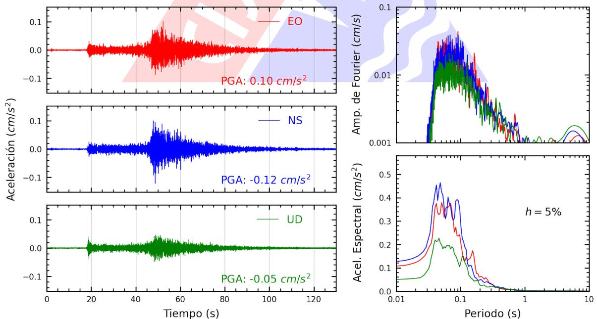
**Figura A.4:** Registros tiempo-historia, espectros de Fourier y de respuesta en las direcciones EO, NS y vertical de la estación UNSA2. Sismo de Tacna, Tacna - Tacna del 2024-06-14, 04:27:18 (Hora local)
