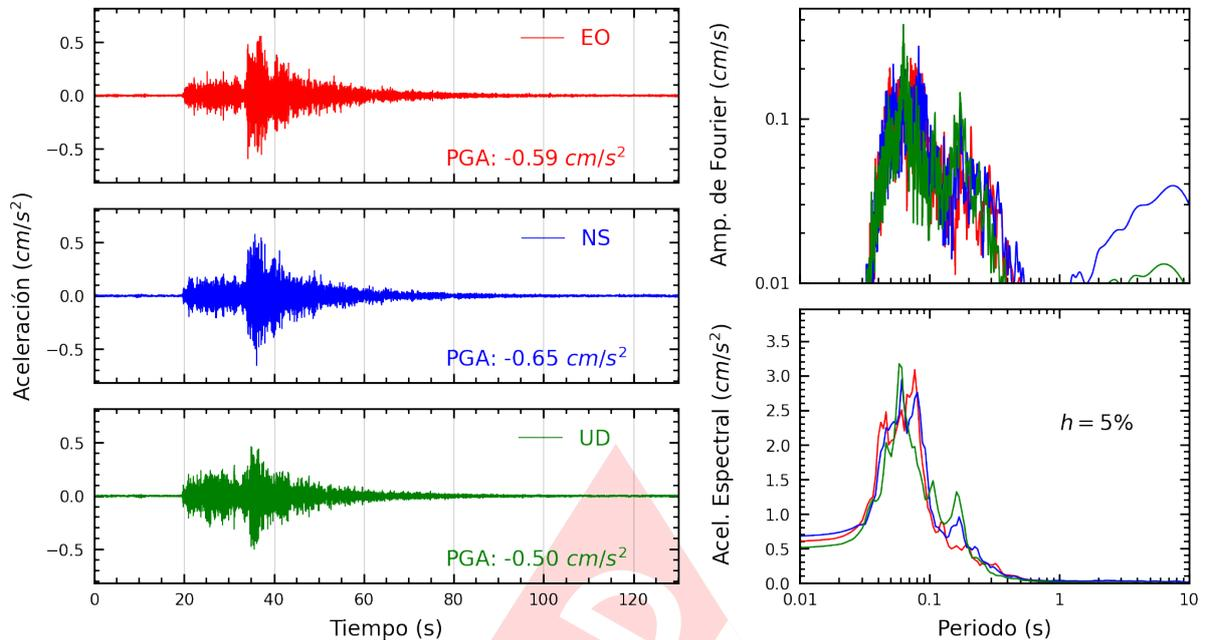
**Figura A.3:** Registros tiempo-historia, espectros de Fourier y de respuesta en las direcciones EO, NS y vertical de la estación CREY. Sismo de Tacna, Tacna - Tacna del 2024-06-14, 04:27:18 (Hora local)
