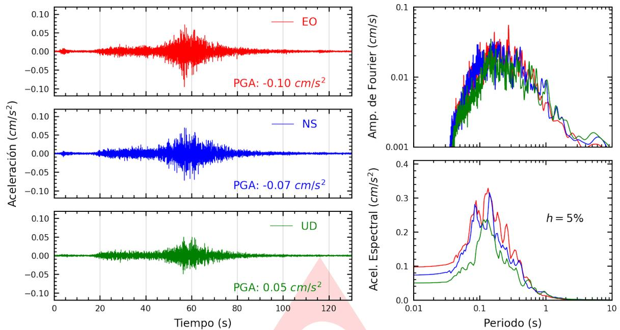
**Figura A.1:** Registros tiempo-historia, espectros de Fourier y de respuesta en las direcciones EO, NS y vertical de la estación UNSA2. Sismo de Chala, Caraveli - Arequipa del 2024-06-16, 21:39:32 (Hora local)
