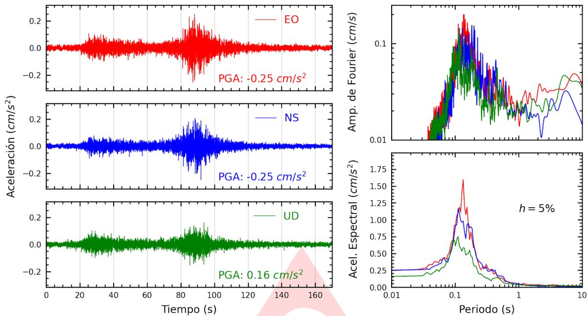
**Figura A.1:** Registros tiempo-historia, espectros de Fourier y de respuesta en las direcciones EO, NS y vertical de la estación AMORE. Sismo de Yauca, Caraveli - Arequipa del 2024-06-22, 15:46:43 (Hora local)
