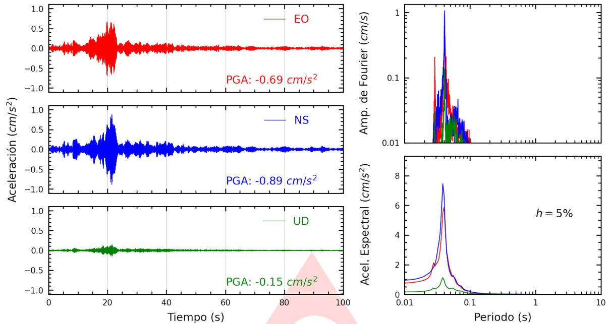
**Figura A.1:** Registros tiempo-historia, espectros de Fourier y de respuesta en las direcciones EO, NS y vertical de la estación UNAM. Sismo de Moquegua, Mariscal Nieto - Moquegua del 2024-08-02, 11:24:58 (Hora local)
