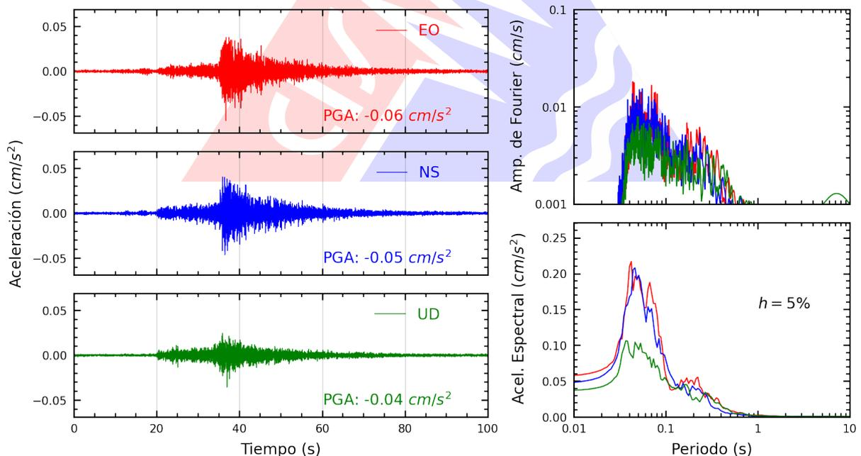
**Figura A.2:** Registros tiempo-historia, espectros de Fourier y de respuesta en las direcciones EO, NS y vertical de la estación UNSA2. Sismo de Moquegua, Mariscal Nieto - Moquegua del 2024-08-02, 11:24:58 (Hora local)
