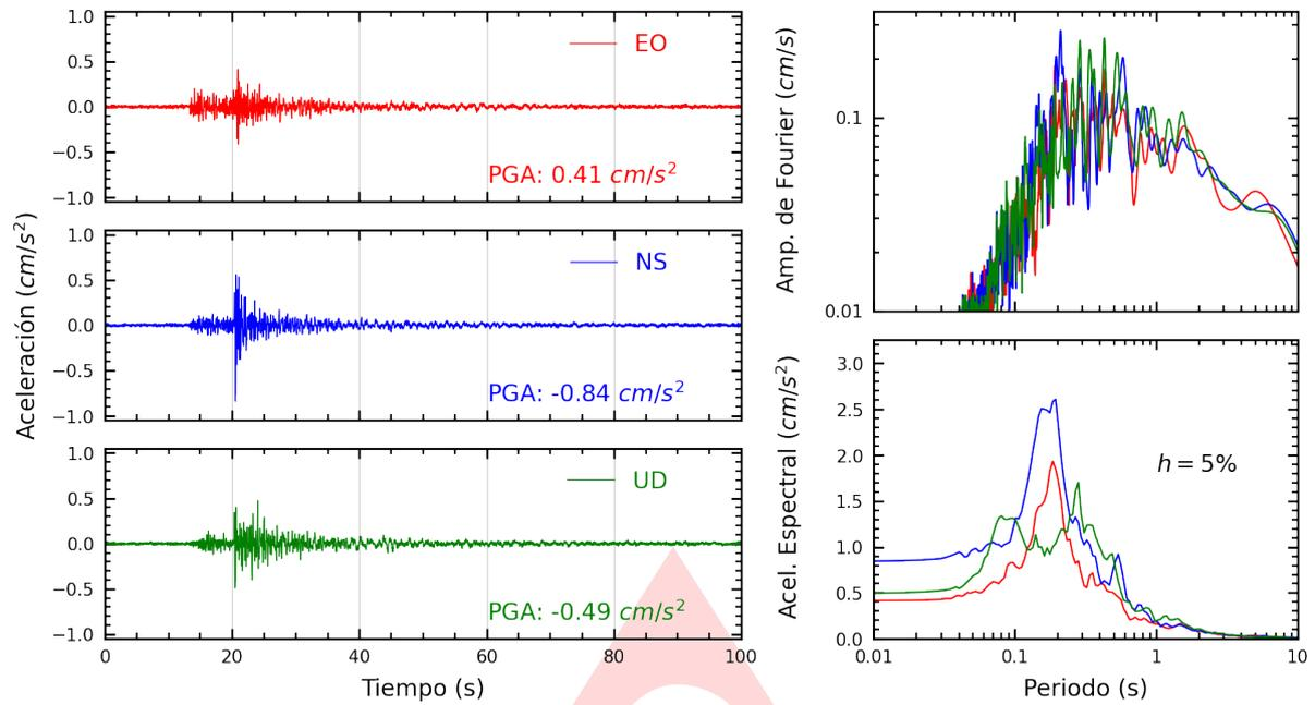
**Figura A.1:** Registros tiempo-historia, espectros de Fourier y de respuesta en las direcciones EO, NS y vertical de la estación UNSCH. Sismo de Cangallo, Cangallo - Ayacucho del 2024-08-31, 15:58:52 (Hora local)
