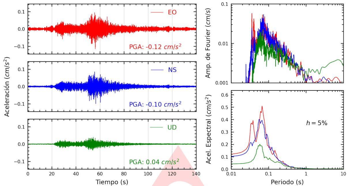
**Figura A.1:** Registros tiempo-historia, espectros de Fourier y de respuesta en las direcciones EO, NS y vertical de la estación UNAM. Sismo de Atico, Caraveli - Arequipa del 2024-09-08, 20:44:51 (Hora local)
