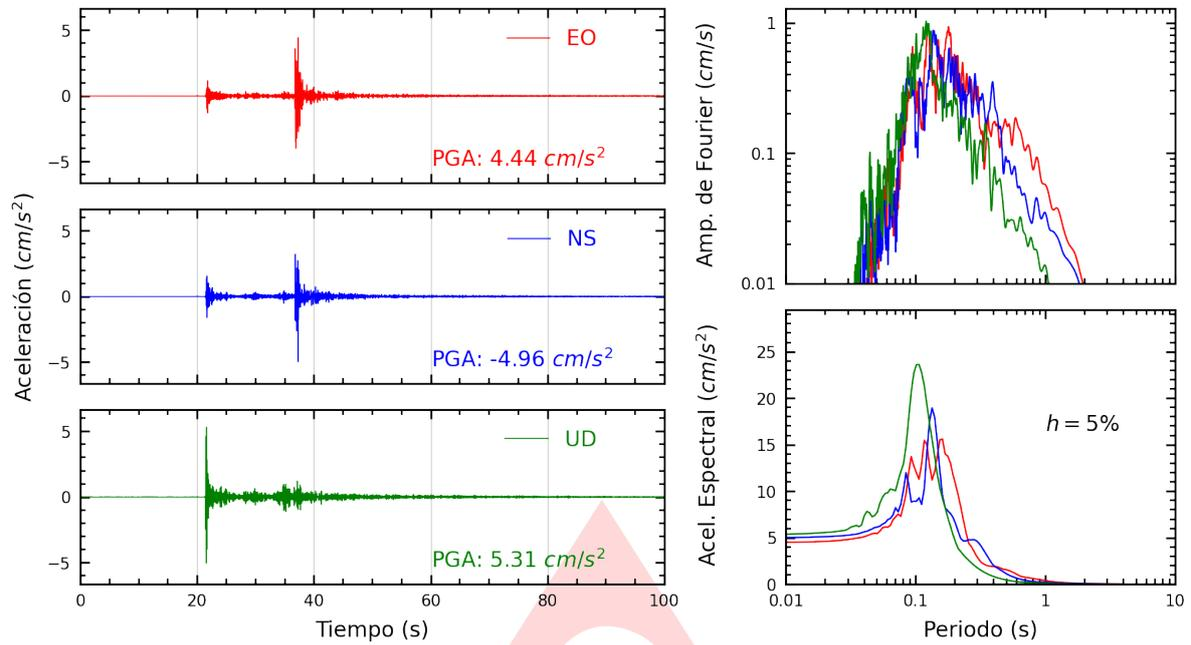
**Figura A.1:** Registros tiempo-historia, espectros de Fourier y de respuesta en las direcciones EO, NS y vertical de la estación UNIA. Sismo de Curimana, Padre Abad - Ucayali del 2024-09-15, 06:29:21 (Hora local)
