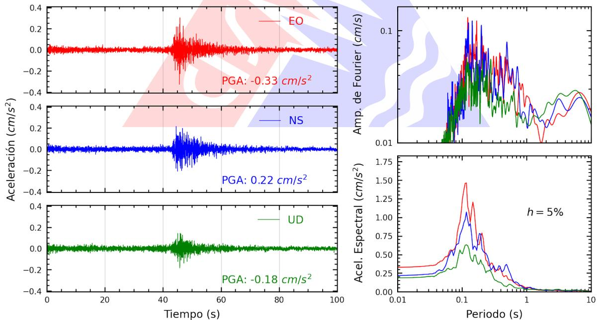
**Figura A.2:** Registros tiempo-historia, espectros de Fourier y de respuesta en las direcciones EO, NS y vertical de la estación UNTRM. Sismo de Curimana, Padre Abad - Ucayali del 2024-09-15, 06:29:21 (Hora local)
