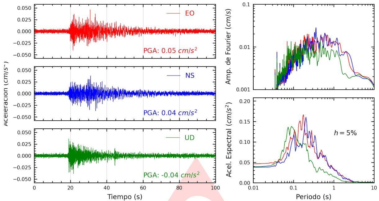
**Figura A.1:** Registros tiempo-historia, espectros de Fourier y de respuesta en las direcciones EO, NS y vertical de la estación UNC. Sismo de Cajabamba, Cajabamba - Cajamarca del 2024-09-20, 01:26:26 (Hora local)
