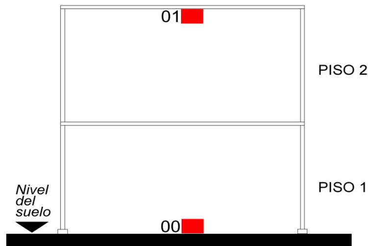
**Figura 4:** Distribución de sensores en la edificación monitoreada
