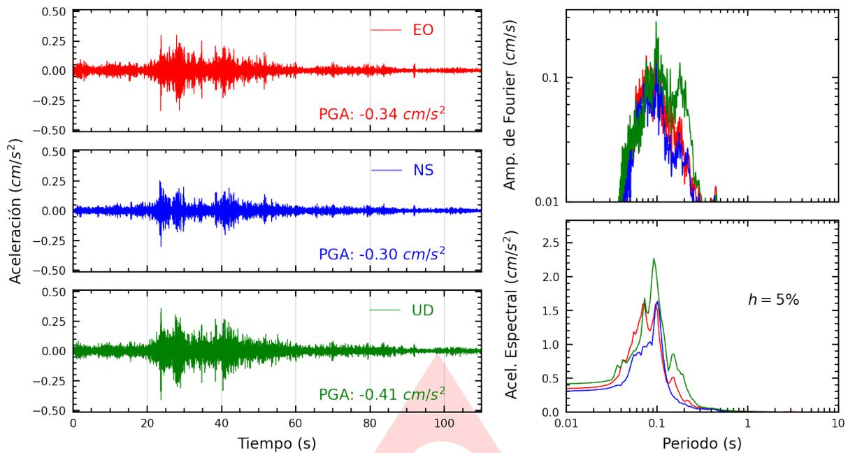
**Figura A.1:** Registros tiempo-historia, espectros de Fourier y de respuesta en las direcciones EO, NS y vertical de la estación UANCV. Sismo de Chivay, Caylloma - Arequipa del 2024-10-06, 16:09:32 (Hora local)
