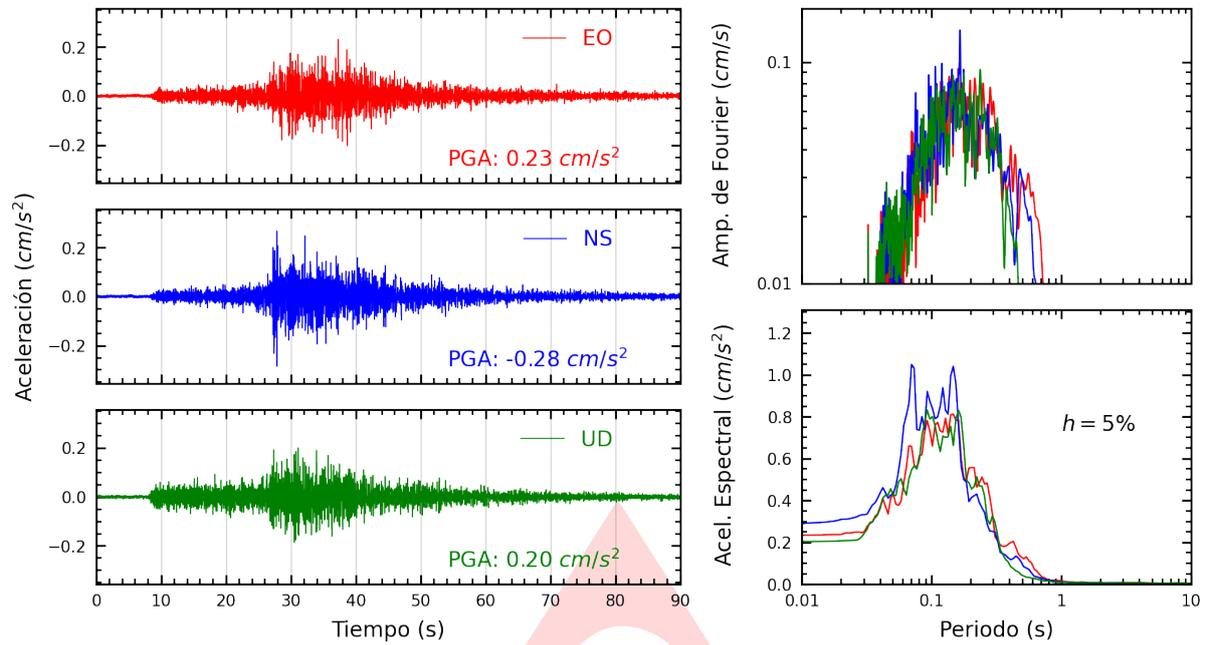
**Figura A.1:** Registros tiempo-historia, espectros de Fourier y de respuesta en las direcciones EO, NS y vertical de la estación CARAL. Sismo de Huarney, Huarney - Ancash del 2024-10-15, 08:49:01 (Hora local)
