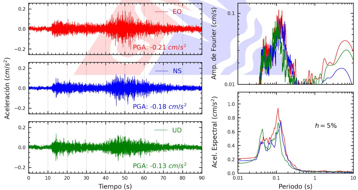
**Figura A.2:** Registros tiempo-historia, espectros de Fourier y de respuesta en las direcciones EO, NS y vertical de la estación AMORE. Sismo de Huarney, Huarney - Ancash del 2024-10-15, 08:49:01 (Hora local)
