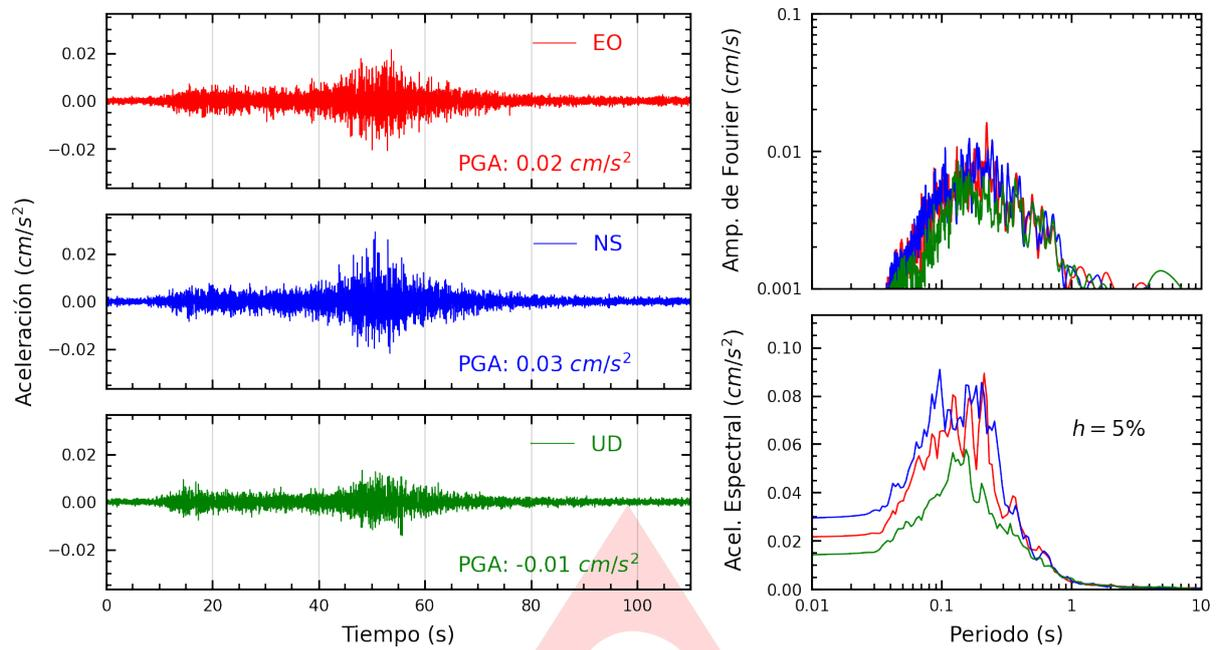
**Figura A.1:** Registros tiempo-historia, espectros de Fourier y de respuesta en las direcciones EO, NS y vertical de la estación UNSA2. Sismo de Yauca, Caraveli - Arequipa del 2024-10-16, 08:52:32 (Hora local)
