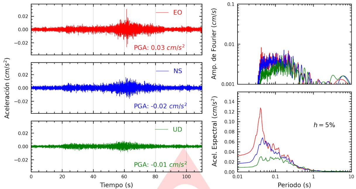
**Figura A.1:** Registros tiempo-historia, espectros de Fourier y de respuesta en las direcciones EO, NS y vertical de la estación UNSA2. Sismo de Chala, Caraveli - Arequipa del 2024-07-29, 13:39:28 (Hora local)
