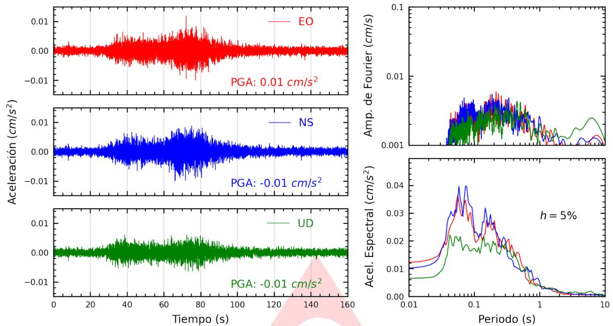
**Figura A.1:** Registros tiempo-historia, espectros de Fourier y de respuesta en las direcciones EO, NS y vertical de la estación UNSA2. Sismo de Lomas, Caraveli - Arequipa del 2024-08-14, 03:51:02 (Hora local)
